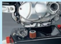
3.1 Ölfilter ohne Gehäuse: Deckel mit neuer Dichtung versehen.
