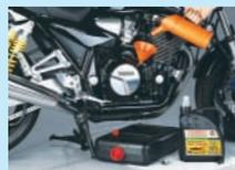
5. Öl auffüllen. Nach kurzer Fahrt nochmals den Ölstand kontrollieren.
