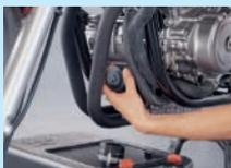
3c. Ölfilter mit der Hand festdrehen – wenn es der Hersteller verlangt, mit Drehmomentschlüssel nachziehen.
