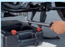
4. Ablassschraube mit neuem Dichtring einbauen und mit Drehmomentschlüssel festziehen.
