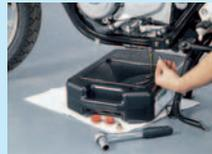
2. Öl ablassschraube lösen und letzte Umdrehungen mit einem Lappen tätigen.
