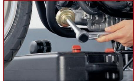
**3a.** Ölfilter mit Gehäuse lösen
