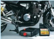
1. Motor warmfahren (nicht heiß). Boden schützen & Einfüllschraube rausdrehen.
