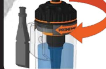
Fülladapter (Teil 17) mit Einfüllstöpsel verbinden. Flasche zusammendrücken um das Öl mit Hilfe des Luftdrucks durch den Förderschlauch zu zwingen. Öl durch den Förderschlauch drücken, bis alle Luftblasen entfernt sind. Belüftungsschlauch (Teil 5) mit Belüftungsgummi verbinden und Schlauch nach oben verlegen.
