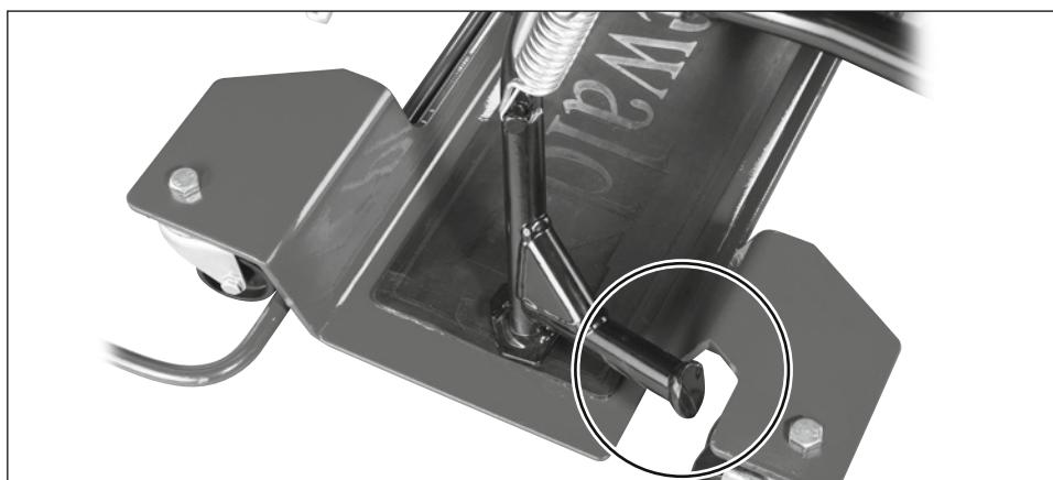
Die Rangierhilfe in einem Winkel von 90 Grad von der linken Fahrzeugseite so unter das Zweirad schieben, dass der Hauptständer in der Metallwanne zu liegen kommen kann, wobei der Hebel der Feststellbremse zum Bediener zeigt. Das Fußpedal des Hauptständers darf den Hebel nicht
