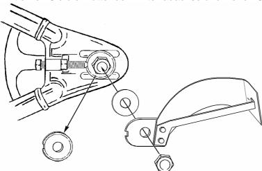
Ersetzen Sie die Achsspannplatte durch den Kennzeichenträger mit Strebe (Bild), legen Sie dabei die Distanzscheibe unter. Stellen Sie die korrekte Riemenspannung wieder ein.
