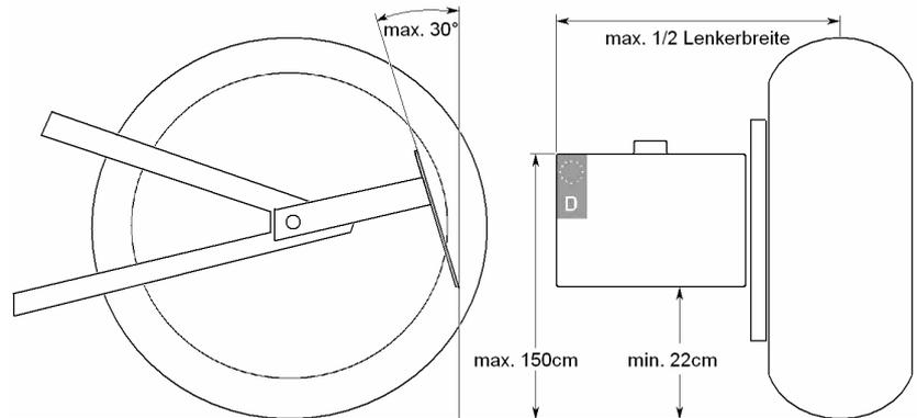
Montieren Sie die Kennzeichenbeleuchtung und schliessen Sie diese an das Bordnetz an. Verlegen Sie das Kabel so, dass es nicht in Kontakt mit dem Hinterrad und der Antriebskette kommen kann und befestigen Sie es mit den Kabelbindern!
