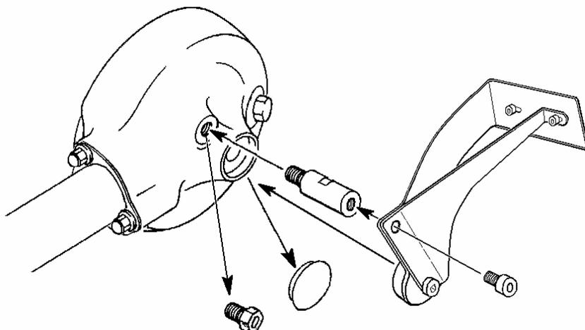
Stecken Sie die Haltebuchse des Kennzeichenträgers in die Öffnung vor der Hinterradachse und schrauben Sie den Halter an dem Bolzen an.
