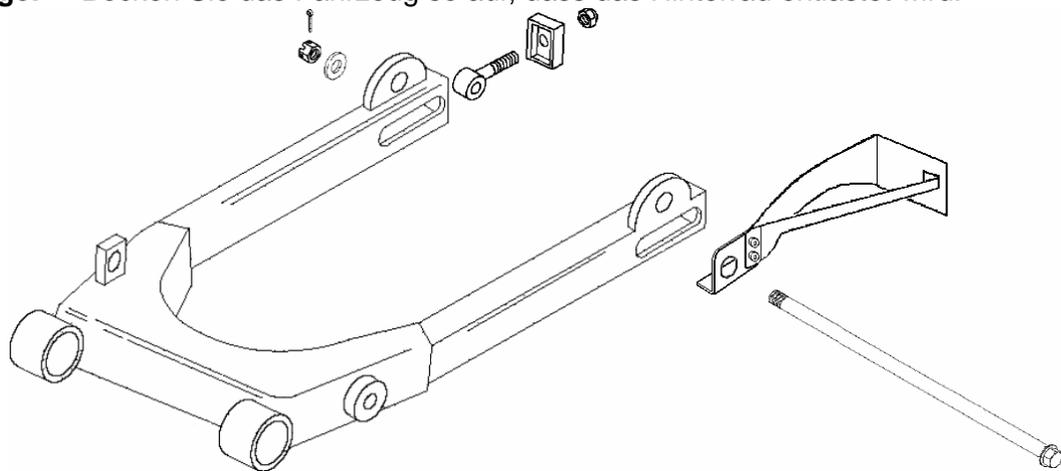
Lockern Sie die Muttern der Riemenspanner. Entfernen Sie den Splint von der Achsmutter und lösen Sie diese. Ziehen Sie die Achse heraus.
