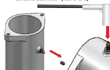
**Hinweis:** Ölen Sie den Unterdruckfilter für einen leichteren Anbau.
