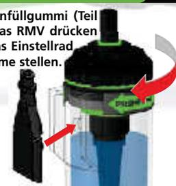
Flasche mit dem Fülladapter verbinden und Flasche zusammendrücken. Öl solange durch den Förderschlauch drücken, bis alle Luftblasen entfernt sind.
