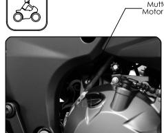
Mutter lösen und Schrauben demontieren Motor mit geeigeneten Hilfsmitteln abstützen
