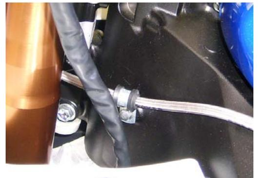
**! Stellen Sie sicher, dass über den gesamten Lenkeinschlag Kabel, Züge und Schläuche spannungsfrei verlegt sind und nicht geknickt werden.**
