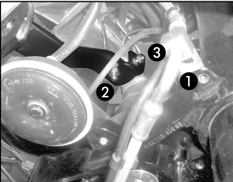
Befestigung des Tankschutzbügels oben:
