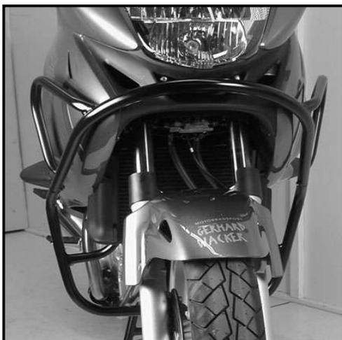
Den Tank- und Motorschutzbügel ausrichten und danach alle Verschraubungen festziehen.
