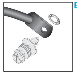
Montage der Lock it System-Schrauben:
