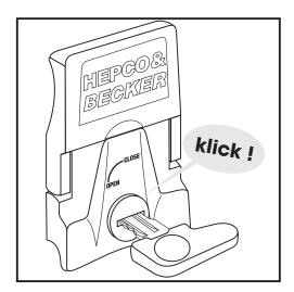
Vor der Montage den Schließzylinder leicht einfetten. Schließzylinder einschieben.
