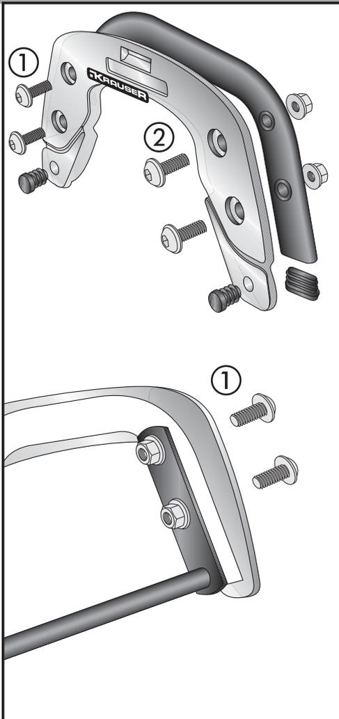
**6** Die Montage des Versteifungsbügels und des Trägerteils K-Wing erfolgt in einem Arbeitsschritt.
