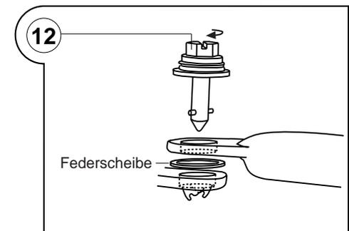
Zur Demontage des QUICK-LOCK-Kofferträgers einfach mit einer Münze oder einem Schraubendreher die Schnellverbinder lösen und Seitenträger entfernen.
