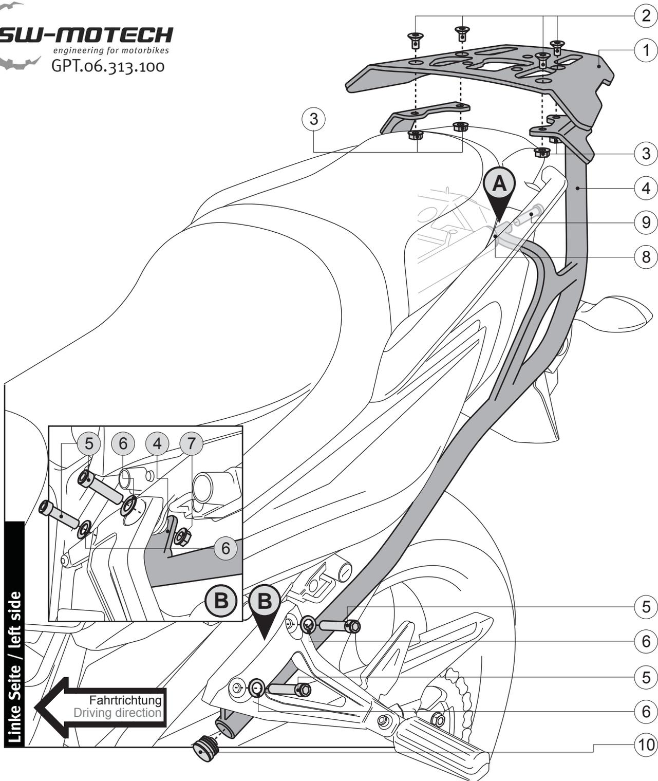
**Montage von Gewindebuche (8) / Mounting of thread spacer (8)**
