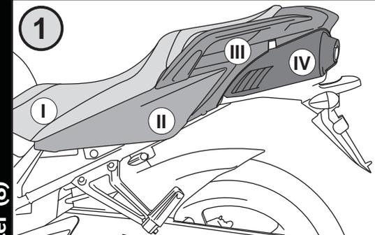
↑ Vor Montage der Unterbau-Streben (4) müssen die gezeigten Verkleidungselemente demontiert werden. Entfernen Sie zuerst die Sitzbank (I), anschließend die Seitenverkleidung (II). Nun kann die Heck (III)- und Auspuffverkleidung (IV) demontiert werden.
