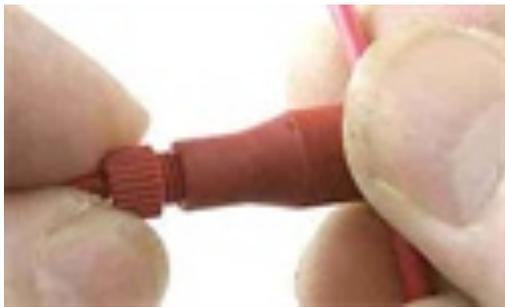
Drücken und drehen Sie die Kappe bis das Gewinde greift. Schrauben Sie die Kappe fest. Achten Sie darauf, dass das Kabel dabei nicht zurückrutscht. Bemerkung: Bei großen Posi-Lock Verbindern, Kappe mit einer Zange festschrauben. Bei kleinen Verbindern genügt handfestes Aufschrauben.
