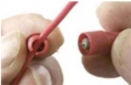
Schieben Sie den Schlitz im Gewinde der größeren Kappe bis zum Anschlag auf das Kabel.
