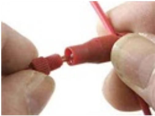
Schieben Sie die Kabellitze auf eine Seite des Metallkonus im Mittelstück des Verbinders.
