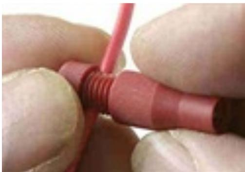
Drehen Sie das Mittelstück des Posi-Tap auf das Gewinde der Kappe. Achten Sie darauf, dass der Dorn des Mittelstücks mittig in das anzuzapfende Kabel eindringt.
