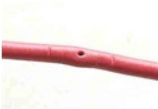
Angezapftes Kabel nach Entfernen des Dorns
