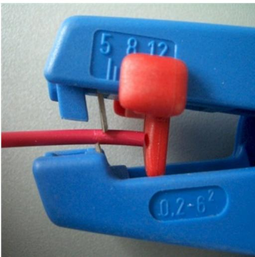
Isolieren Sie das Kabel vorsichtig in der erforderlichen Länge ab. Achten Sie darauf, dass keine Litze des Kabels beschädigt oder abgeschnitten wird.
