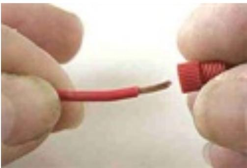
Schrauben Sie die Kappe ab. Stecken Sie das Kabel vollständig durch das Loch in der Kappe.
