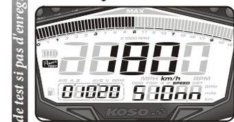
Appuyez sur le bouton **Réglage** pour effacer l'enregistrement et accéder à l'écran de test de vitesse max. Par ex : Maintenant vous voyez votre enregistrement précédent. Le compteur affiche une vitesse max. de 180 km/h, la distance pour atteindre la vitesse max. est de 510 m, la vitesse de rotation max. est de 10 000 tours/min lors du test, la durée nécessaire pour atteindre la vitesse max. est de 10"20 secondes.
