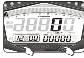
Sur l'écran d'accueil, appuyez une fois simultanément sur les boutons Réglage et Sélection pour passer du compteur de vitesse numérique au tachymètre numérique.
