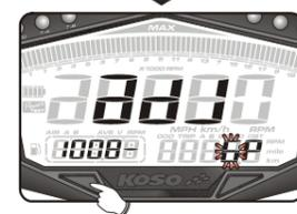
Par ex. : Le réglage du point de détection passe de 1 P à 6 P.
