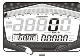
Sur l'écran de la température B, appuyez une fois sur le bouton Sélection pour passer de la fonction température B à la fonction voltmètre.
