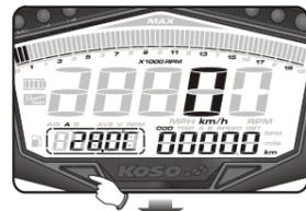
Sur l'écran de la température A, appuyez une fois sur le bouton Sélection pour passer de la fonction température A à température B.
