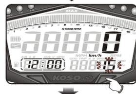
Sur l'écran du compteur d'heures totales, appuyez sur le bouton Réglage pour passer du compteur d'heures totales à l'enregistrement Max.
