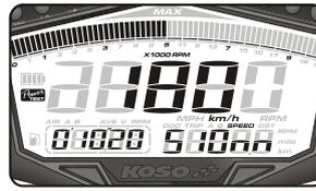
Si vous atteignez la vitesse max. (180 km/h), le compteur de durée cessera de compter la distance (510 m), et la durée (10"20 secondes). Pour refaire le test, appuyez sur le bouton **Réglage** pour effacer l'enregistrement et réaccéder à l'écran de test du compteur de durée de vitesse cible.
