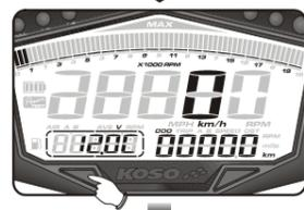
Sur l'écran de tension, appuyez une fois sur le bouton Sélection pour passer de la fonction Volt à la Jauge de carburant.
