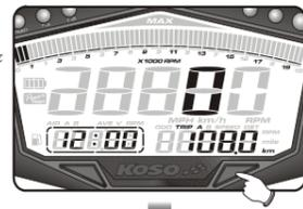
Sur l'écran du KM A, appuyez sur le bouton Réglage pour passer du Km A au Km B.
