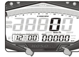
Sur l'écran d'accueil, appuyez sur Sélection & Réglage X pendant 3 secondes pour saisir le réglage de la circonférence du pneu et du point de détection.
