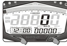
Sur l'écran d'accueil, maintenez enfoncés les boutons Sélection et Réglage en même temps pendant 6 secondes pour accéder à l'écran de test de puissance. (Pour en savoir plus, voir la section 5-1.)
