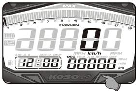
● Sur l'écran d'accueil, appuyez sur **Réglage** pendant 3 secondes pour accéder au réglage du test de l'indicateur de vitesse max.
