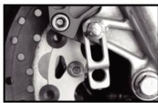
Installez le support de capteur de type s.
