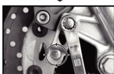
Réglez la position du support de capteur pour vous assurer que le capteur est en face de l'aimant pour éviter un mauvais signal de vitesse ou une absence de signal.
