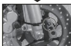
Utiliser le collier de câble pour fixer le support sur la fourche avant. Assurez-vous que la vis du disque passe dans le trou sur le support pour installer le capteur dans le même trou pour la détection du signal de vitesse.
