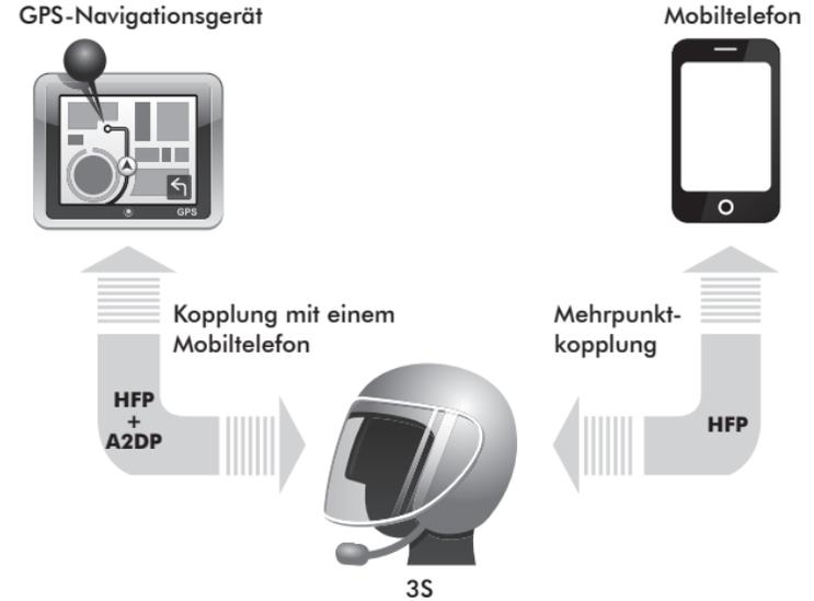
Kopplung des GPS-Navigationsgeräts als Mobiltelefon
