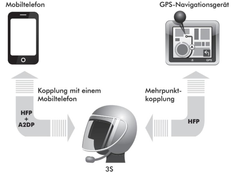
Mehrpunktverbindung des GPS-Navigationsgeräts
