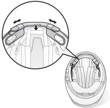
4. Ziehen Sie die Schutzfolie der Klettverschlüsse für die Lautsprecher ab, sodass jeweils die Seite mit der Klebefläche offen liegt. Bringen Sie die Klettverschlüsse an den Ohransparungen an der Helminnenseite an.
