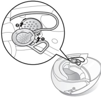
3. Entriegeln Sie die beiden Schnellhalter der mittleren Polsterung an der Rückseite und stecken Sie das Akkufach zwischen die äußere und die innere Schale. Drücken Sie die beiden Laschen durch den Schnellhalter des Akkufachs.
