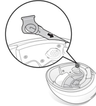
5. Richten Sie den linken Lautsprecher auf die Basis der linken Wangenpolsterung aus und führen Sie die zwei Klammern in die entsprechenden Nuten ein.
