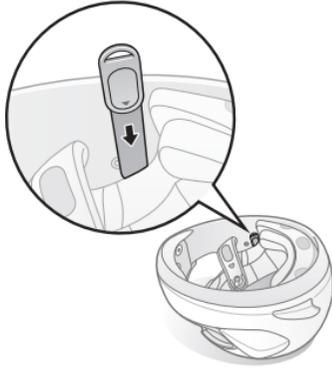
4. Nehmen Sie die Schutzfolie des Klebebandes der Steuerungseinheit ab und befestigen Sie es an Ihrem Helm.
