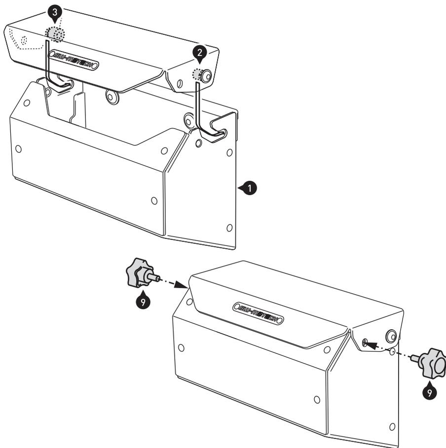
Setzen Sie nun den Deckel auf die Werkzeugbox und verschließen Sie diesen mit den Sterngriffschrauben (9).
