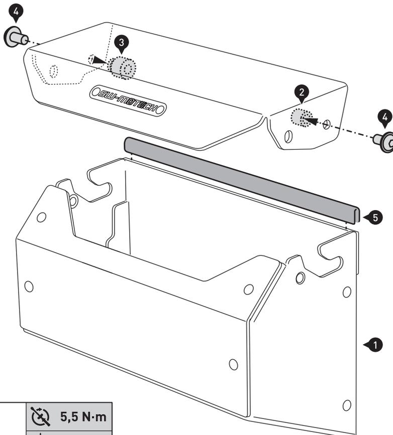
Verschrauben Sie die Führungsbuchse (2) und Verschlussbuchse (3) am Deckel. **ACHTUNG: Verwenden Sie flüssige Schraubensicherung!** Ziehen Sie die Schrauben wie in der Stückliste vorgegeben an.
