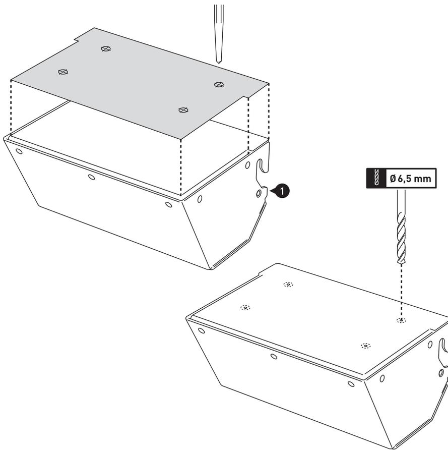
Legen Sie die Ihrem Fahrzeug entsprechende Schablone auf die Rückseite der Werkzeugbox (1). Achten Sie auf die korrekte Ausrichtung der Schablone und sichern Sie diese mit Klebestreifen gegen Verrutschen. Nutzen Sie nun einen Körner, um die Bohrmittelpunkte von der Schablone auf die Werkzeugbox (1) zu übertragen. Entfernen Sie die Schablonen und bohren Sie mit einem 6,5-mm-Bohrer die Öffnungen. Entgraten Sie anschließend die Bohrungsänder.
