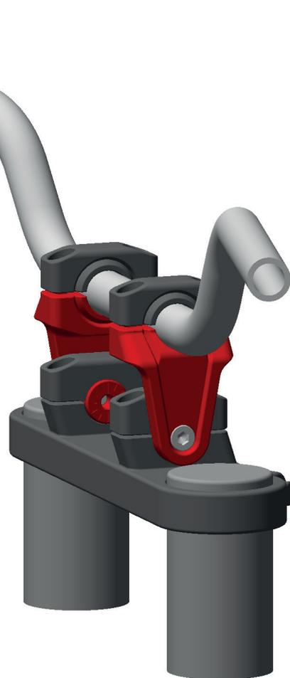
bei unbedingt ein maximales Drehmoment von 25 Nm sowie die Herstellerangaben!
