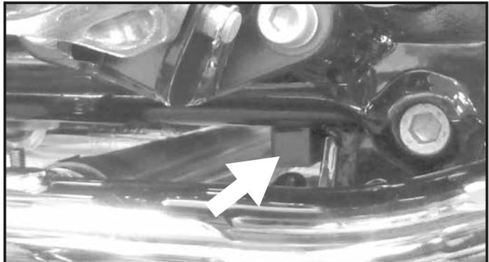
Den Endtopf wieder montieren und alle Schrauben fest anziehen. Den oberen Anschlag an der Sechskantschraube M8x35 einstellen. **Achtung! Schräglagenfreiheit sowie Luftspalt zwischen Endtopf und Ausleger beachten!**
