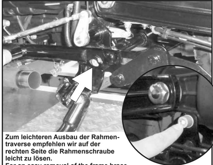
Zum leichteren Ausbau der Rahmentraverse empfehlen wir auf der rechten Seite die Rahmenschraube leicht zu lösen.
