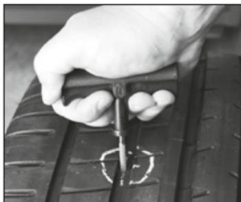
Steek het 2-in-1 reparatiegereedschap (1) in het gat in de band. Reinig het beschadigde gebied door de ruimer herhaaldelijk in het beschadigde gebied te steken en er weer uit te trekken. Verwijder alle vuil op de plaats van de lekkage. Het beschadigde gebied mag maximaal een diameter van 4,5 mm hebben.
