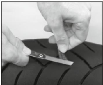
Se necessario, è possibile accorciare il nastro di tenuta di circa 6 millimetri (calcolato dalla superficie esterna dello pneumatico).
