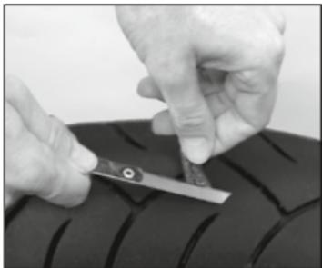
Der Dichtstreifen kann bei Bedarf auf ungefähr 6 Millimeter (von der äußeren Oberfläche des Reifens aus berechnet) verkürzt werden.
