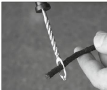
Trek een afdichtstrook van de beschermfolie en steek deze in het naaldoog van het reparatiegereedschap.
