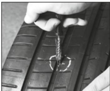
Insérez la mèche de réparation dans la zone endommagée à l'aide de l'aiguille porte-mèche, tout en le laissant dépasser d'au moins 13 mm.
