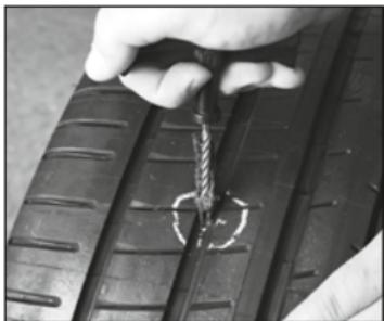
Den Dichtstreifen mithilfe des Reparaturwerkzeuges in die Schadstelle stecken und mindestens noch 13 Millimeter herausragen lassen.
