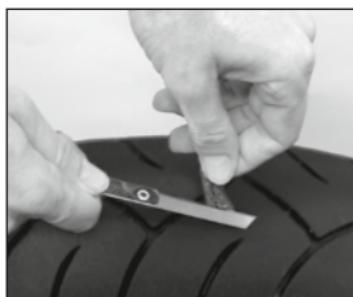
Au besoin, la mèche de réparation peut être raccourcie à environ 6 mm (en mesurant à partir de la surface extérieure du pneu)
