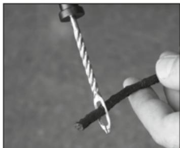
Einen Dichtstreifen von der Schutzfolie abziehen und in das Nadelöhr des Reparaturwerkzeuges einführen.
