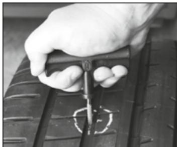
Inserire l'utensile di riparazione 2 in 1 (1) nel foro sullo pneumatico. Pulire il punto danneggiato inserendo ed estraendo più volte l'alesatore nel punto danneggiato. Qualsiasi traccia di sporco deve essere rimossa dal punto di foratura. Il punto danneggiato deve avere un diametro massimo di 4,5 mm.
