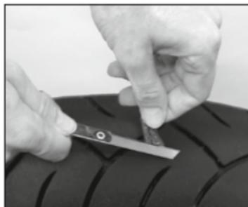
Indien nodig kan de afdichtstrook tot ongeveer 6 millimeter worden ingekort (geteld vanaf het buitenoppervlak van de band).
