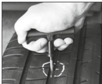
Das 2-in-1 Reparaturwerkzeug (1) in das Loch im Reifen einstechen. Die Schadstelle reinigen, indem die Ahle mehrfach in den Verlauf der Schadstelle ein- und ausgeführt wird. Jeglicher Schmutz muss aus der Einstichstelle entfernt werden. Die Schadstelle darf max. einen Durchmesser von 4,5 mm haben.
