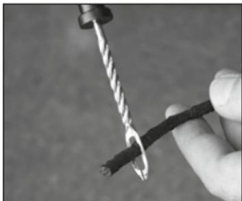
Retirer une bande d'étanchéité du film de protection et l'insérer dans le chas de l'aiguille de l'outil de réparation.
