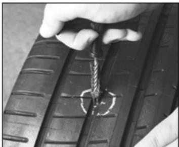
Infilare il nastro di tenuta nel punto danneggiato con l'ausilio dell'utensile di riparazione e lasciarlo sporgere in fuori di almeno 13 millimetri.
