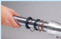
6. Mehrmals ruckartig am Standrohr ziehen.
