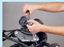
1. Erst die Klemmungen der oberen Gabelbrücke, dann die Verschlußstopfen lösen.
