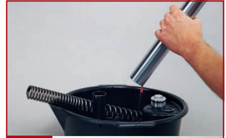
3. Obere Gabelverschlusschraube entfernen und Gabelöl ausgießen
