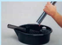
3. Obere Verschluss-schraube, Gabelfedern etc. entfernen und altes Gabelöl auskippen.
