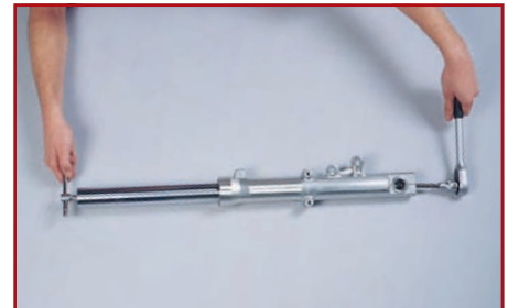
4. Untere Gabelverschlusschraube entfernen
