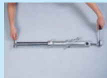
4. Untere Gabelverschlußschraube entfernen. Beim Zusammenbau unbedingt Dichtring erneuern.
