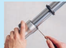
4. Untere Gabelverschlußschraube entfernen. Beim Zusammenbau unbedingt Dichtring erneuern.
