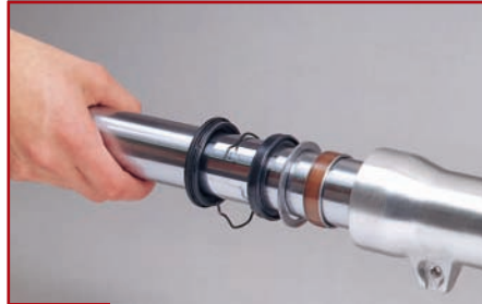
6. Defekten Dichtring entfernen
