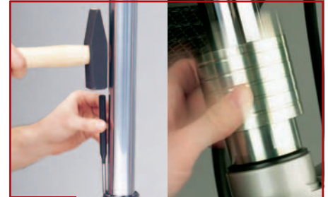
7. Montage mit Hammer, oder besser: Gabeldichtring-Eintreiber
