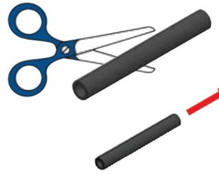
Couper la durite et insérer la pièce en T (Partie 7). Appliquer le manchon (Pièce 4) sur la pièce en T et raccorder le tube de la pompe (Pièce 3) au manchon
