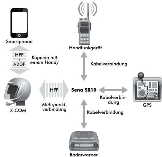
Parallele Verbindung des SR10 und des Handys per Bluetooth-Mehrpunktkopplung
