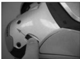
2) Die Abdeckung an der linken Wangenseite abnehmen, indem Sie den Schieber nach vorne schieben.
