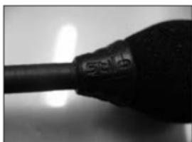
5) Vergewissern Sie sich, dass die geprägten Punkte am Kopf des Mikrofons zum Inneren des Helmes gedreht sind.
