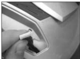
3) Den 8-poligen Stecker zwischen Innen- und Außenschale durchstecken bis das Kabel aus der Spalte herausragt. Den Stecker in die Bluetooth Vorrichtung einstecken und die Vorrichtung in den Sitz unterbringen.
