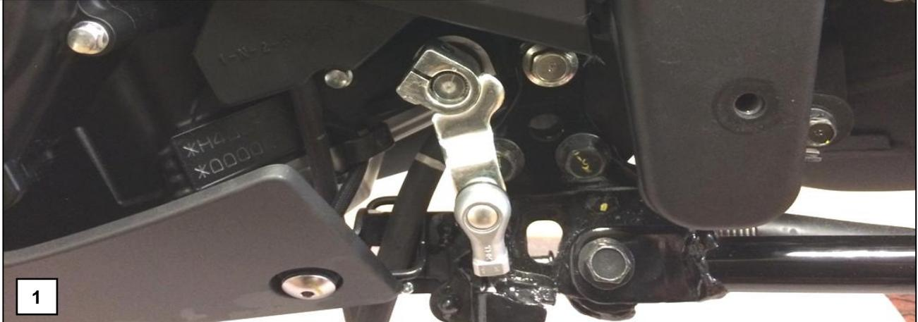
1: Originale Rastenanlage demontieren
