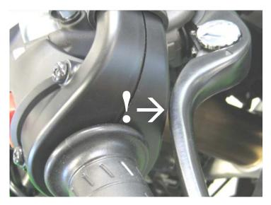
Den Tour-Match durch verdrehen der Klemmschellen auf dem Standrohr nachjustieren und abschließend die Klemmschrauben mit 10Nm festziehen. Nun die Griffarmaturen ausrichten und die zur Verdrehsicherung nötigen Bohrungen setzen. Das linke Griffgummi sollte mit geeignetem Klebstoff montiert werden.
