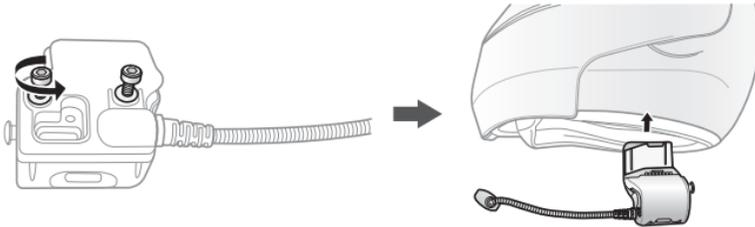
2. Je nach Größe und Form Ihres Helms müssen Sie evtl. ein dickeres/dünnere Gummipolster zwischen die Klemmplatten legen. Im Karton finden Sie zwei zusätzliche Gummipolster. Um die Gesamtdicke zu erhöhen, befestigen Sie das dünnere am Original-Gummipolster oder tauschen Sie das Original-Gummipolster gegen das dickere aus.
