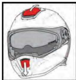
Öffnen der vorderen Belüftungsdüsen
