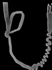
Le cordon d'attache doit être fixé au cadre de la moto, sous la selle. Choisir un tube ou une partie de la structure non acéré pour ne pas risquer de couper le cordon d'attache.
