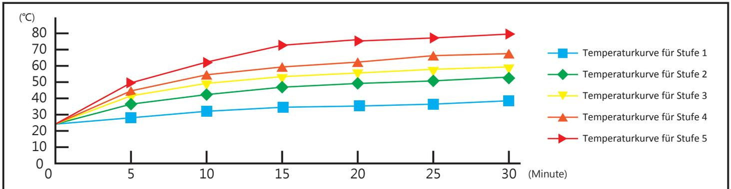
**HINWEIS** Die Testumgebung ist unter 25 Grad Celsius, mit einer Arbeitsspannung von 13,5 V.
