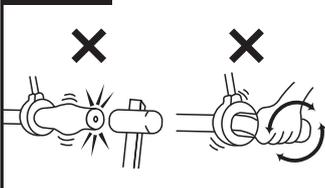
**⚠ VORSICHT!** Verwenden Sie zur Montage kein Werkzeug, um den Griff auf den Lenker zu schlagen. Verdrehen Sie den Griff nicht von Hand oder mit einem Werkzeug. Dadurch wird der Draht im Inneren des Lenkers gebrochen oder beschädigt.
