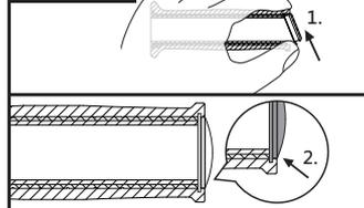
1. Um die Seitenkappe auf den beheizbaren Griff zu montieren, setzen Sie das Oberteil der Kappe in die obere Nut ein und drücken Sie sie dann nach unten in die untere Nut.
