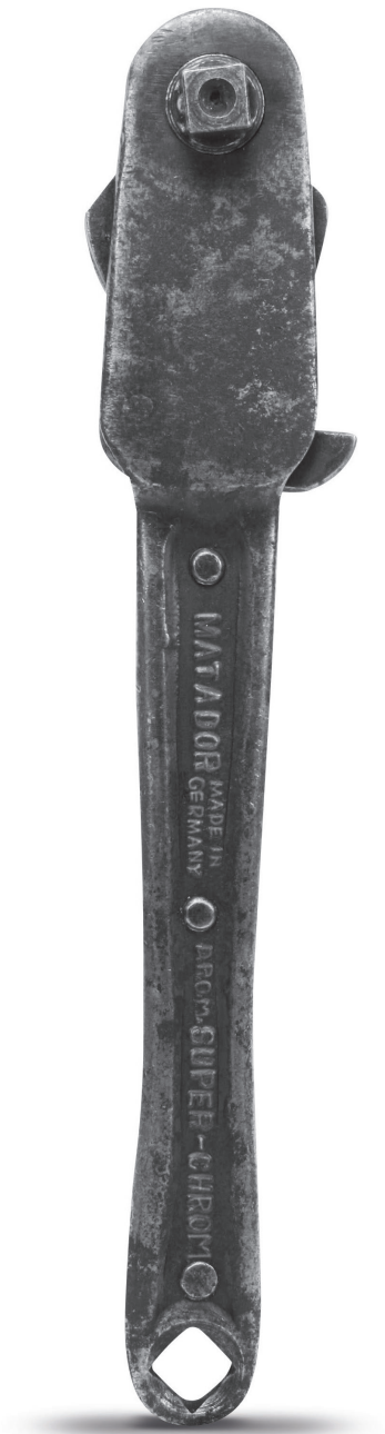
1919. Die erste Hebelumschaltknarre.
