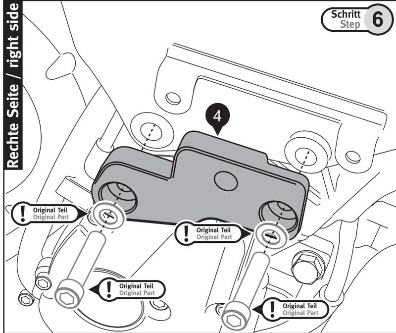
Verschrauben Sie die Montageplatte (4) mit den originalen Schrauben und Unterlegscheiben, wie in der Zeichnung gezeigt. Achten Sie dabei auf das vom Hersteller vorgeschriebene Anzugsmoment.
