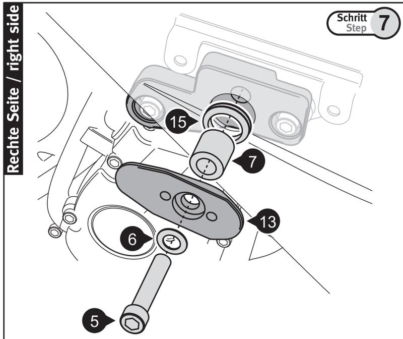
Montieren Sie die rechte Seitenverkleidung. Setzen Sie die Gummitülle (15) in die gebohrte Öffnung ein. Montieren Sie die Teile (5), (6), (7) und (13), wie in der Zeichnung gezeigt. Richten Sie vor dem Anziehen der Schraube (5) die Basisplatte (13) entsprechend der Linienführung des Fahrzeugs aus. Ziehen Sie Schraube (5) an.
