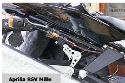
Die optimale Einstellung sind ein bis zwei Tropfen in der Minute. Die Nummern auf dem Einstellknopf des RMV **entsprechen nicht** den Tropfen per Minute. Die Zahlen sind nur für Sie zur Orientierung angebracht, damit Sie z.B. nach dem Entlüften einfach die gleiche Einstellung finden. Sie müssen nach dem Einbau noch den Einfüllgummi entfernen und den Einstellknopf noch drehen können.
