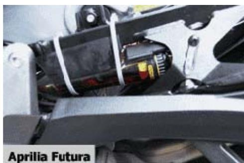
Wenn Sie Luftblasen im Förderschlauch haben, müssen Sie das System neu entlüften – wie in der Montageanleitung und hier weiter unten im Bild beschrieben. Blasen verhindern, dass der Scottoiler ordentlich arbeitet. Es ist wichtig, dass das RMV keiner zu großen Hitze, wie z.B. Motor oder Auspuff, ausgesetzt wird. Wenn das Öl im RMV zu warm wird, wird sich die Fließrate erhöhen und die Kette dadurch zu stark geschmiert.
