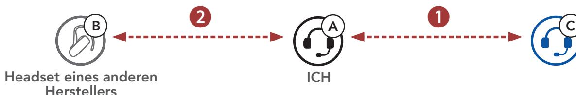
2. Starten Sie mit einem Bluetooth-Headset eines anderen Herstellers (**B**) die Kommunikation über die Sprechanlage in Ihrer Sprechanlagengruppe. Beispielsweise können **Sie (A)** über die Sprechanlage die Kommunikation mit dem Bluetooth-Headset eines anderen Herstellers (**B**) beginnen. Alternativ kann der Gesprächsteilnehmer mit dem Bluetooth-Headset eines anderen Herstellers (**B**) **Sie (A)** über die Sprechanlage anrufen.
