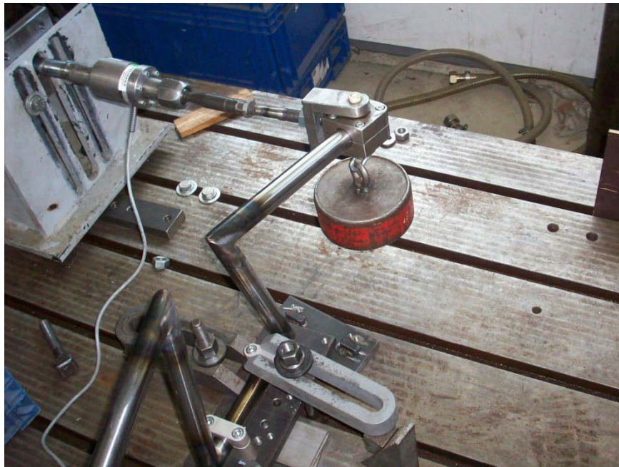
Prüfmuster auf Hydropulser / Test sample on hydro puls test bench
