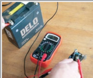
Tester le circuit du relais de démarrage
