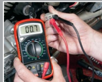
...et contrôle de circuit ouvert
