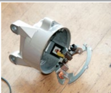
Ces balais de charbon sont encore en bon état
