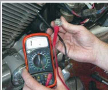
Contrôle de court-circuit à la masse du stator (résistance infinie)...
