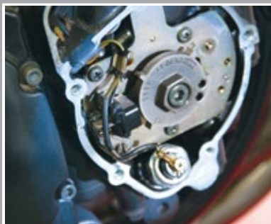
Bobine collectrice du boîtier d'allumage
