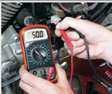
Mesure de la tension de charge non redressée...
