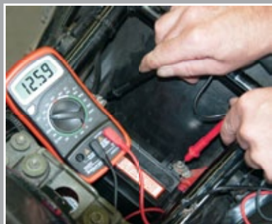
Mesure de la tension de la batterie : tension de repos...
