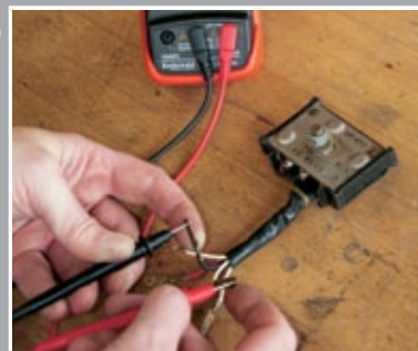
Mesure de la résistance du redresseur dans un sens...
