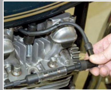
Tester la tension d'allumage à l'aide du testeur d'allumage
