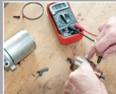
Effectuer le test du circuit entre les rainures du collecteur
