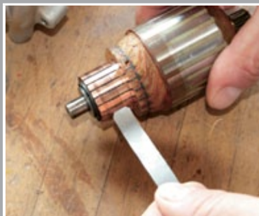
Contrôler la profondeur des rainures du collecteur
