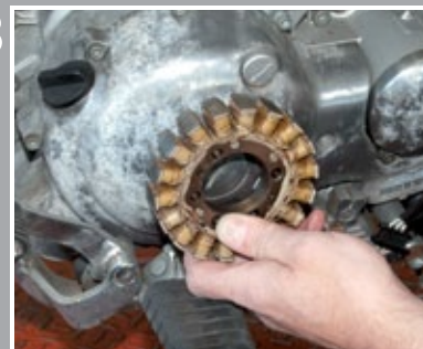
Stator d'un alternateur monté en étoile
