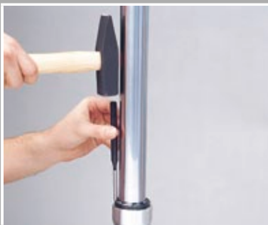
Montage mit Hammer oder Gabeldichtring-Eintreiber
