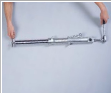
Untere Gabelverschluss-schraube entfernen
