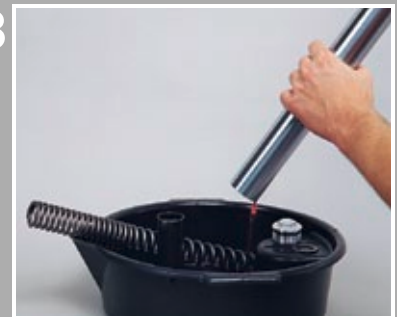
Obere Gabelverschluss-schraube entfernen, Gabelöl ausgießen
