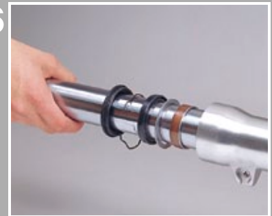
Defekten Dichtring entfernen
