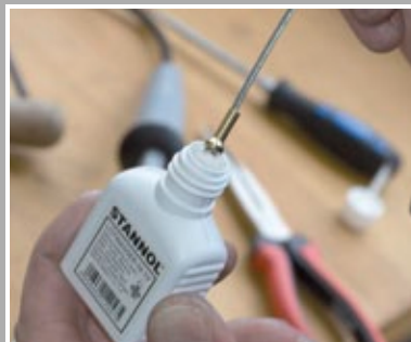
Bowdenzugende mit Löt-Nippel in Lötwasser reinigen
