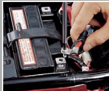
Zuerst das Pluskabel und dann das Minuskabel befestigen
