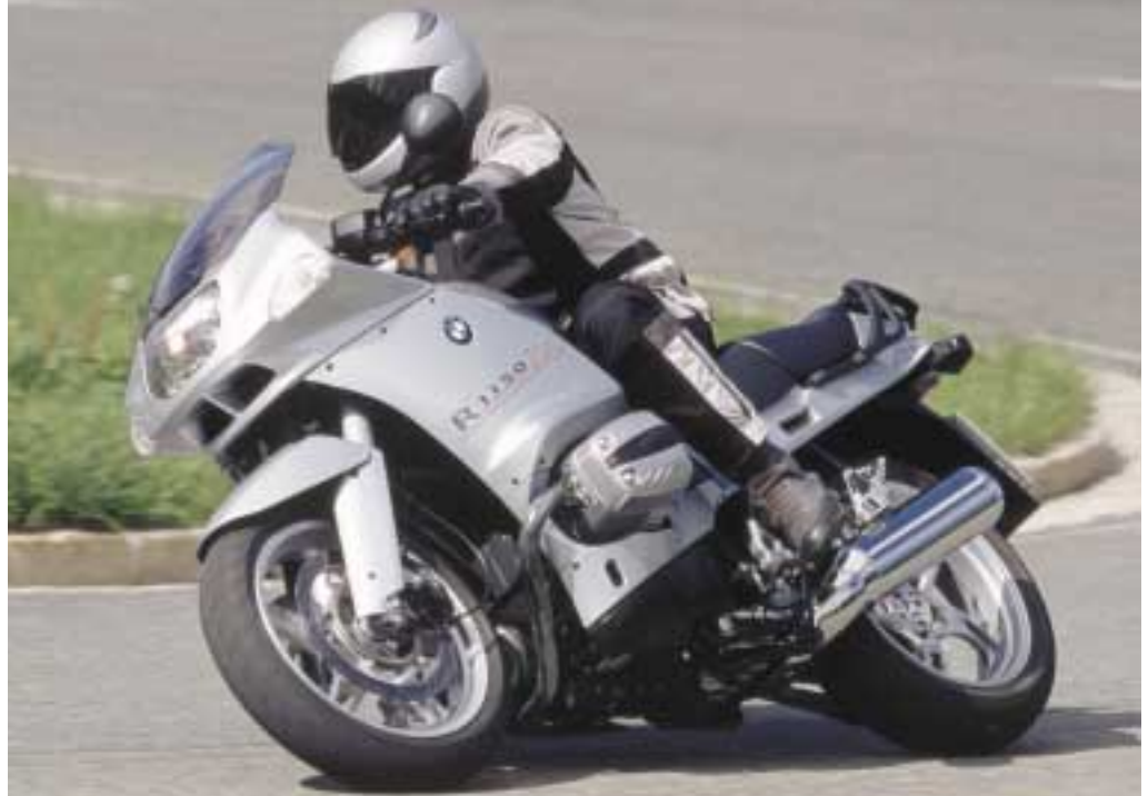
Das Telelever-System vorn ist für Fahrsicherheit und ausgezeichneten Fahrkomfort verantwortlich.
