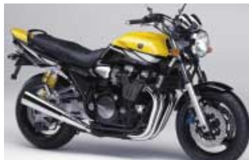
Die entspannte Sitzposition, ein guter Soziusplatz und der langstreckentaugliche 21-Liter-Tank machen die 1300er allroundtauglich.
